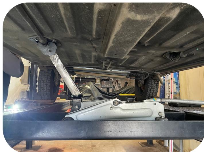
*Mise en tension de la barre de torsion*
