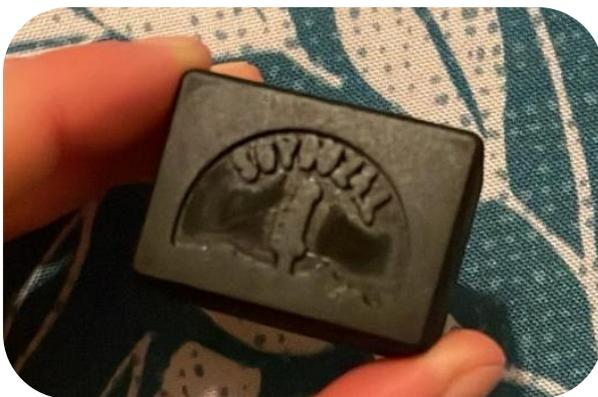
*Bouchons de barre de toit en impression 3D*
