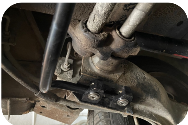
Accroche de la nouvelle barre stabilisatrice arrière
