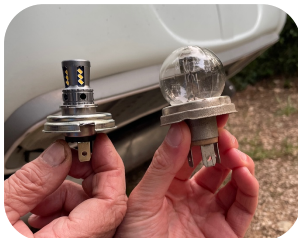
Ampoule LED à gauche et ampoule à filament à droite
