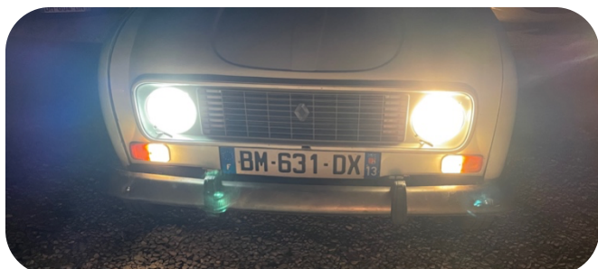
Ampoule LED à gauche et ampoule à filament à droite
