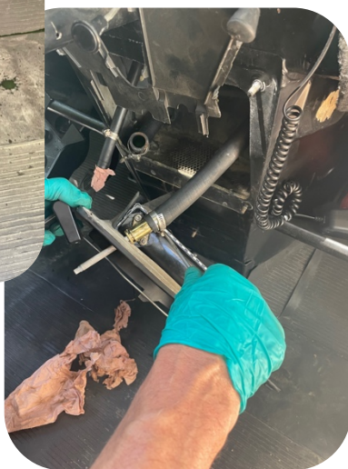
Mise en place du radiateur
